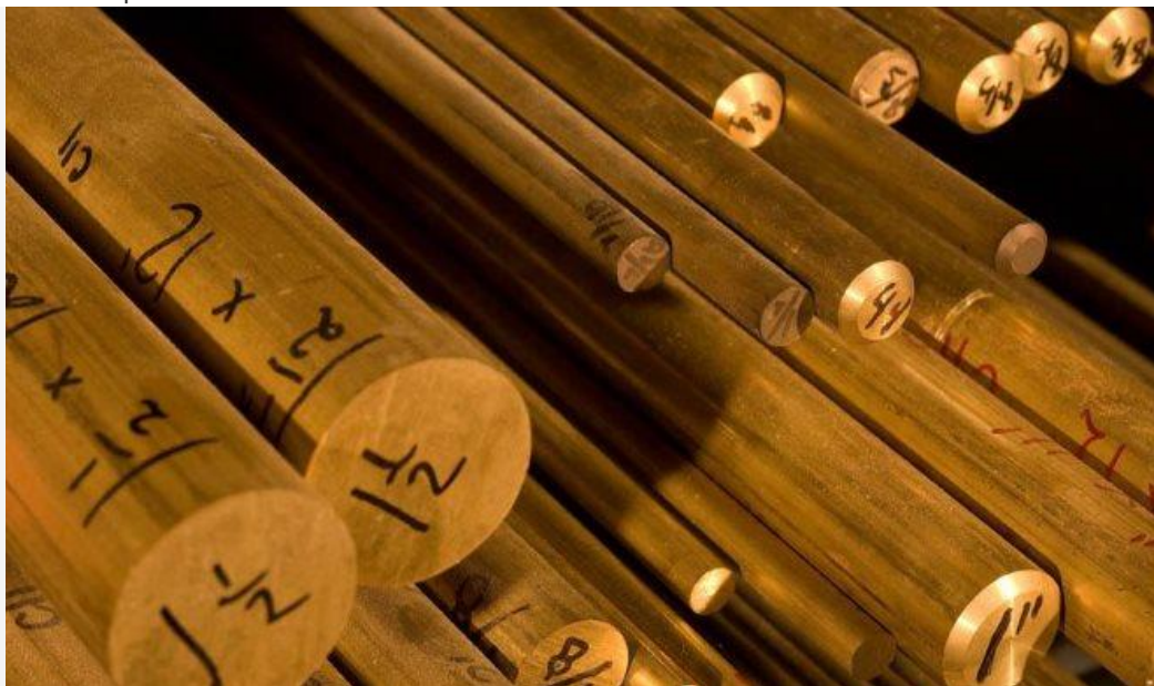
Автоматная латунь марки ЛС59-1 используется для изготовления метизов и декоративных элементов
